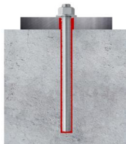
Кольцевой зазор заполнен клеевым составом
