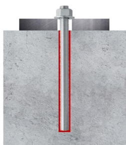
Кольцевой зазор не заполнен клеевым составом
